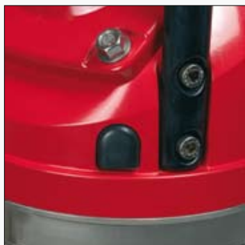
Воздушный клапан Не дает насосу перегреться при работе «всухую»
